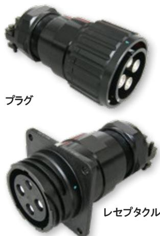
ITS 901シリーズは、ITSシリーズの拡張型で、AWG#1/0以上のケーブル用の多極コネクタで、嵌合防水設計です。AWG#4~262 MCM (35~120 mm<sup>2</sup>)の電源ケーブルに対応しており、電流容量は最大450Aまで、使用電圧はAC800~1000Vです。負荷側ピンコンタクトの先端は、感電を防止するための対策が施されており、誤嵌合防止として3つの極性キーがあり、プラグのカップリングナットに着脱を楽にするゴム成形加工をすることも可能です。
