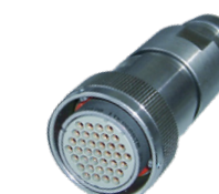
ITKシリーズ セラミックインサート 15分間700℃耐久設計
