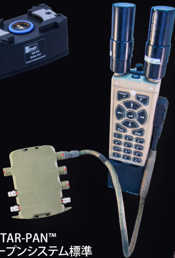
STAR-PAN™ 無線機 データ伝送/電源設定用アダプタ Mighty Mouse 807一体ケーブル
