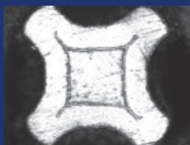
ワイヤと ツイストピンコンタクトの 圧着部のカット断面
