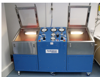
圧力試験装置
